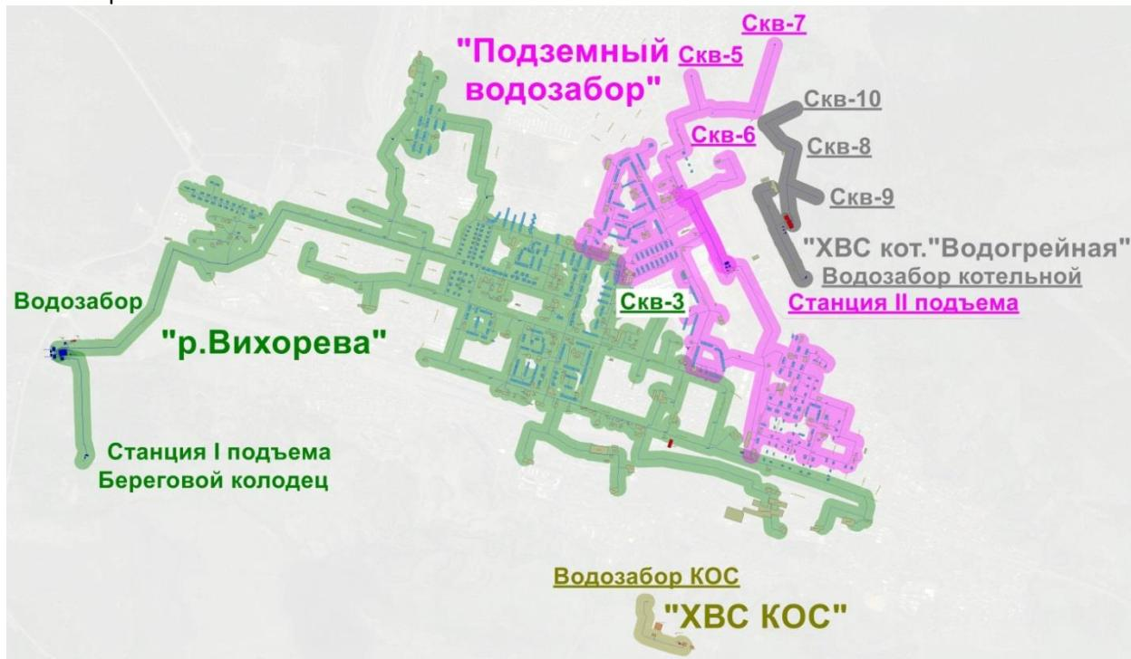
**Рис.2.3.1.1. Общая принципиальная схема централизованного холодного водоснабжения Вихоревского городского поселения**
