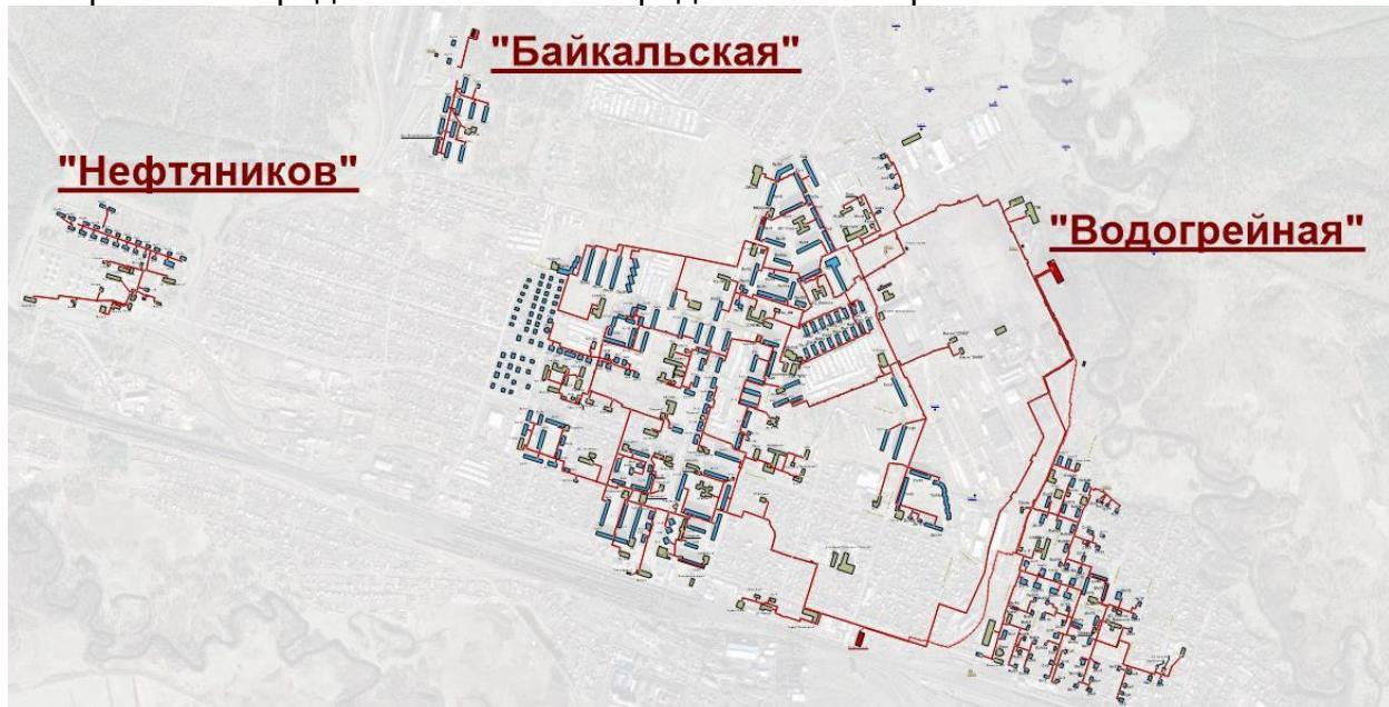
**Рис.2.3.1.2. Принципиальная схема централизованного теплоснабжения Вихоревского городского поселения**
