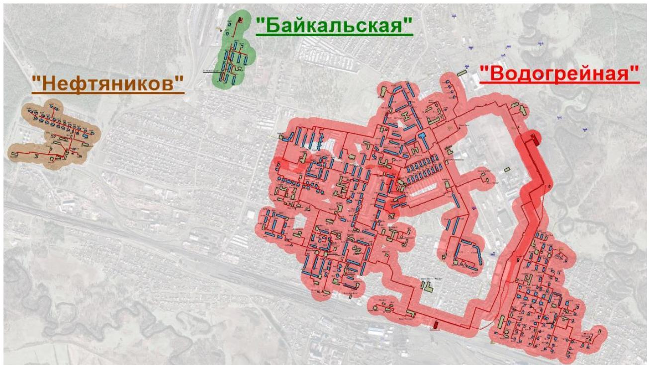
**Рисунок 9.5.5.1. Зоны действия централизованного теплоснабжения Вихоревского городского поселения**
